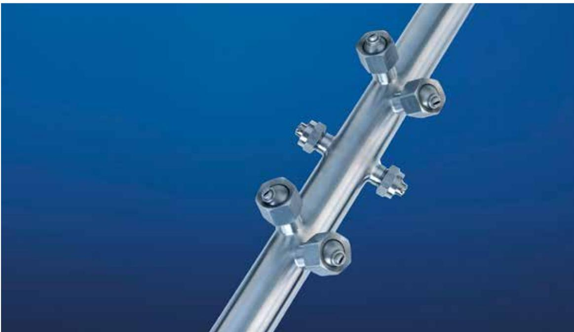
Anlauffarben im Bereich der Schweißnaht der CIP-Lanzen stören nicht nur die Optik, sondern sind auch ein Hygienierisiko. Die durch die Anlauffarben angerauten Oberflächen sind ein Einfallstor für Rost und ein Ort, an dem sich Bakterien niederlassen können. Daher bietet Dockweiler mehrere Verfahren zum Entfernen der Anlauffarben an, z.B. Nassreinigung und Beizen.
